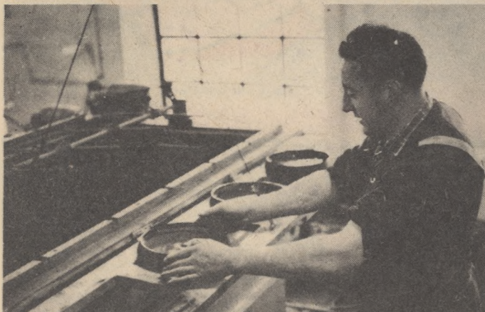
3. Dépôt d'argent. Un mouvement de rotation aux fines particules d'argent de se déposer sur le « flanc ».
